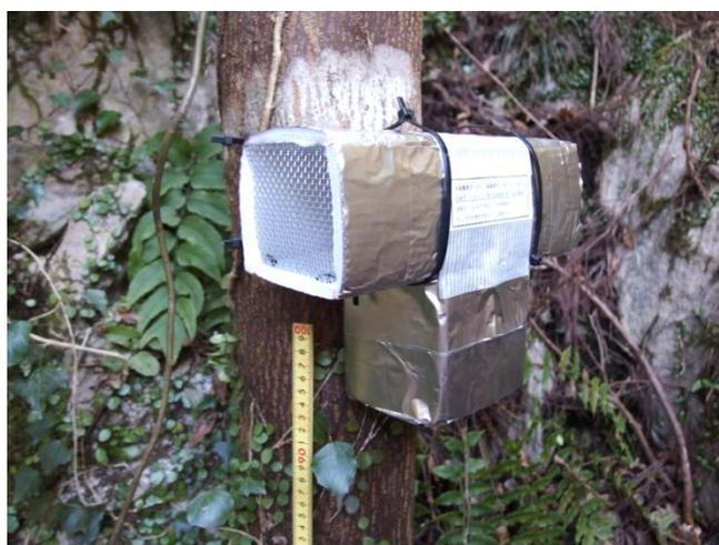
写真 6 気象観測用の温湿度ロガー設置例（秋吉台ドリーネ B, 地点②）
