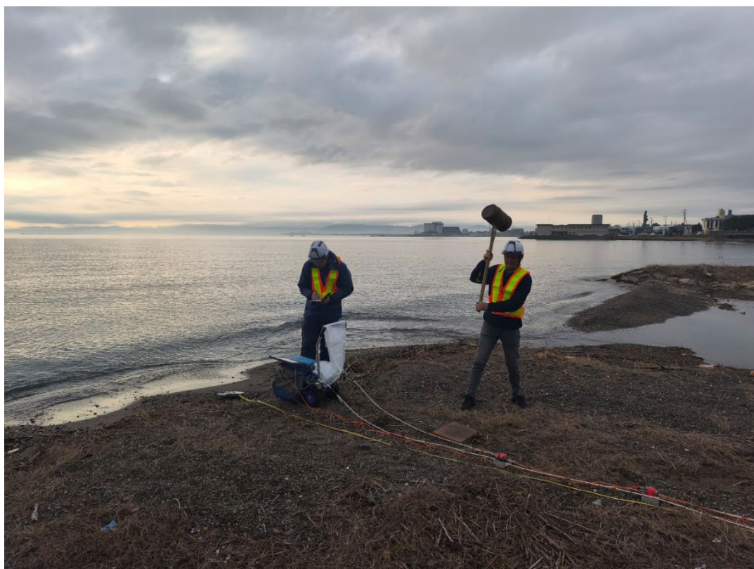
図－7 陸上表面波探査の状況
