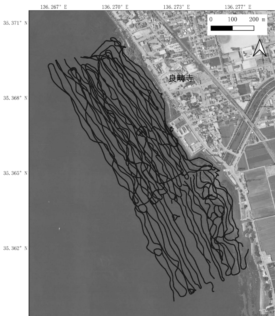
図-9 下坂浜千軒遺跡周辺の GNSS 連動ソナーの調査測線
