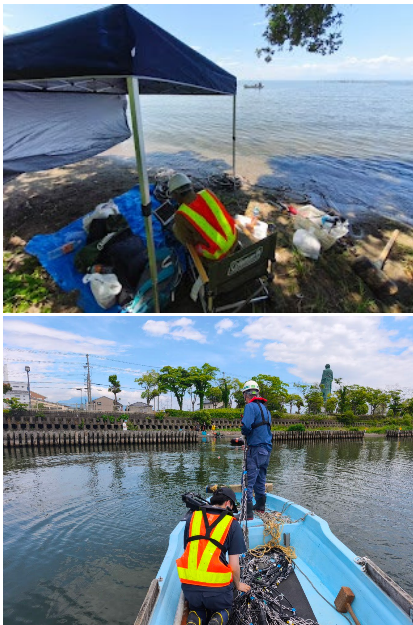
図-8 水中表面波探査の状況，下がハイドロフォンの施設作業
