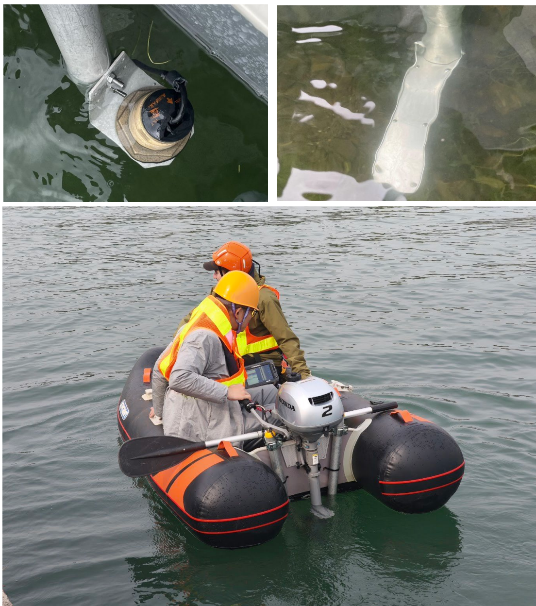
図ー5 GNSS 魚群探知機による調査の状況
